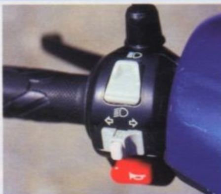
▲ Biały przycisk na suwaku kierunkowskazów służy do ich wyłączenia.
