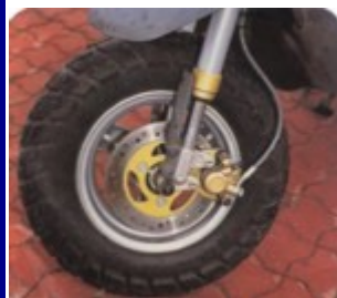
Przedni hamulec tarczowy skutecznie redukuje drogę hamowania.
