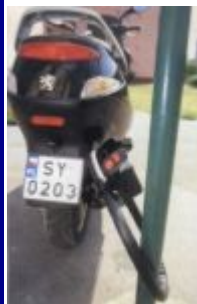
Fabrycznie montowany stalowy boa pozwala skutecznie przytwierdzić pojazd na przykład do latarni.
