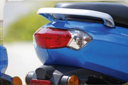
▲ Wszystko, co wystaje, może się oderwać, więc kierunki wkomponowano w lampę.
